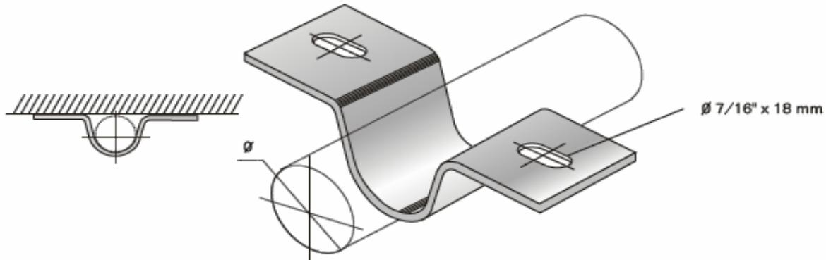
**ADVERTENCIA:** Sólo puede usarse de forma horizontal, ya que no aprieta totalmente el tubo para permitir la dilatación longitudinal.
